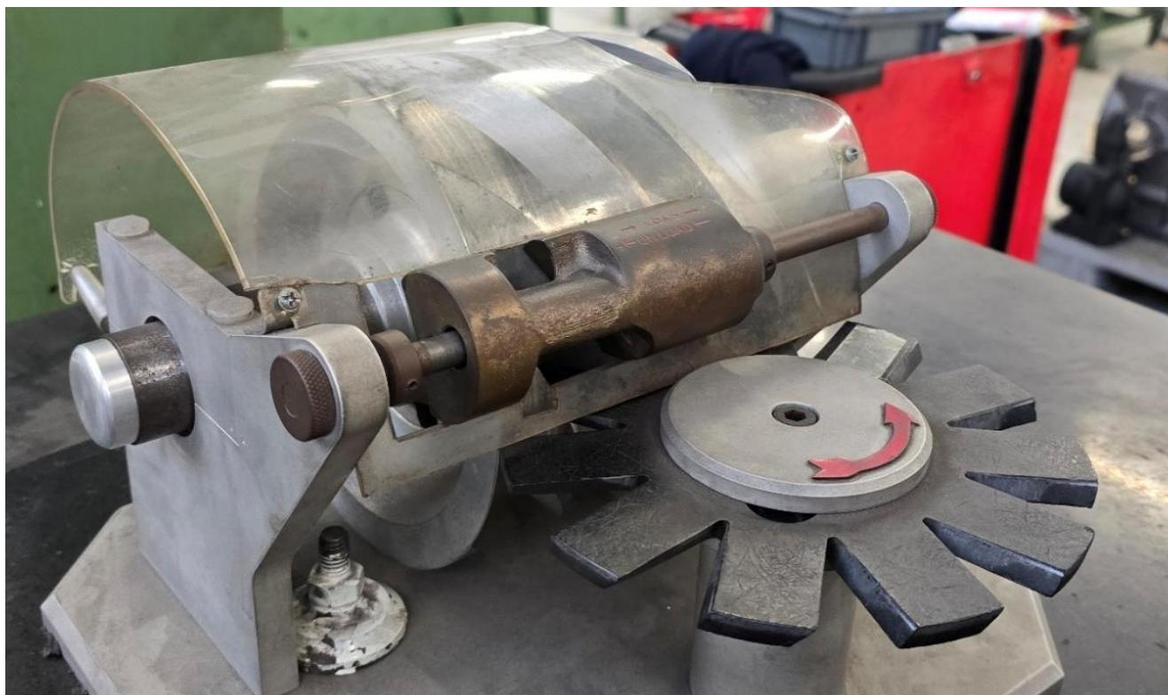
**Figura 9 – Montagem interna de Compressor Monoparafuso com Válvula Deslizante**
