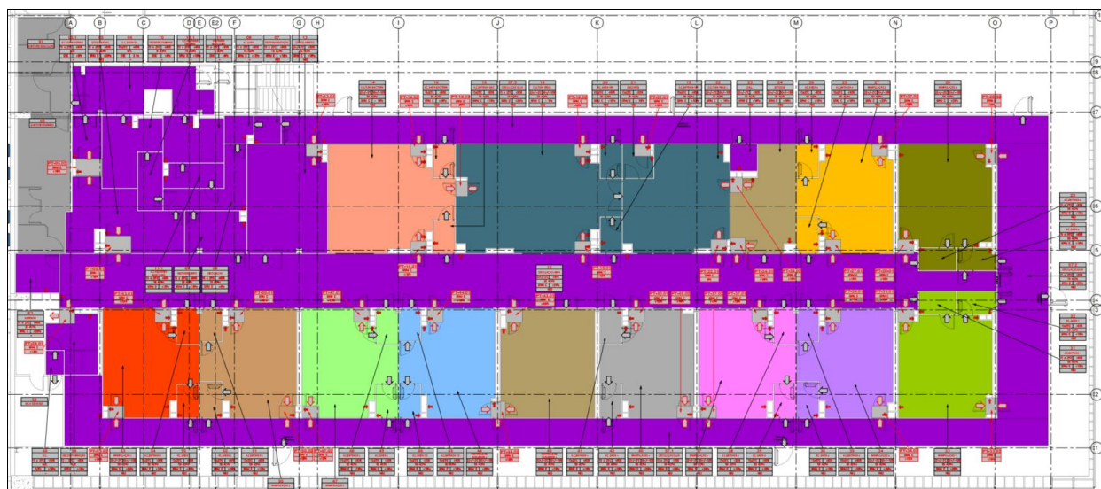
Figura 3 – Zoneamento de sistemas de HVAC
