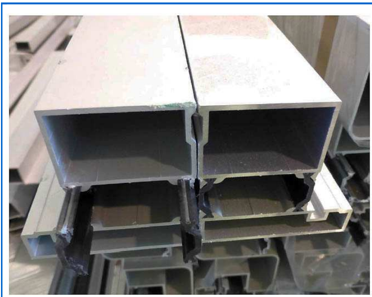
Figura 2 – Perfis estruturais duplos intermediários Cortesia: Daikin-McQuay
